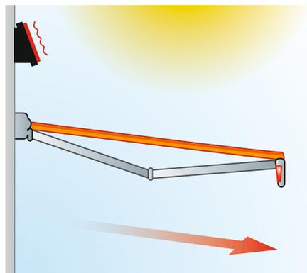
Quand le soleil brille de façon intense, votre store descend automatiquement grâce à des capteurs de température ou d'ensoleillement.
